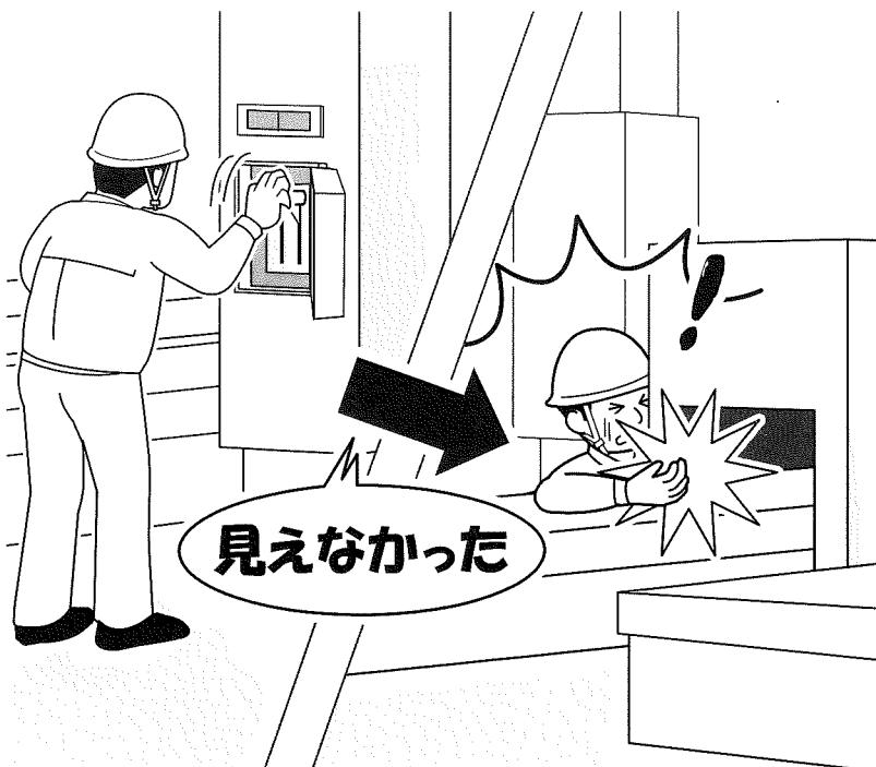
『災害のあらまし』製品の包装工場で、包装ライン（長さ10m）の一部の調子が悪かつたため、担当者が休憩時間中に点検・調整をしていましたところ、休憩が終わって他の作業者が包装ラインの起動スイッチを入れたため、修理中だった作業者が右手を機械に挟まれて休業3カ月の重傷を負つたものです。
