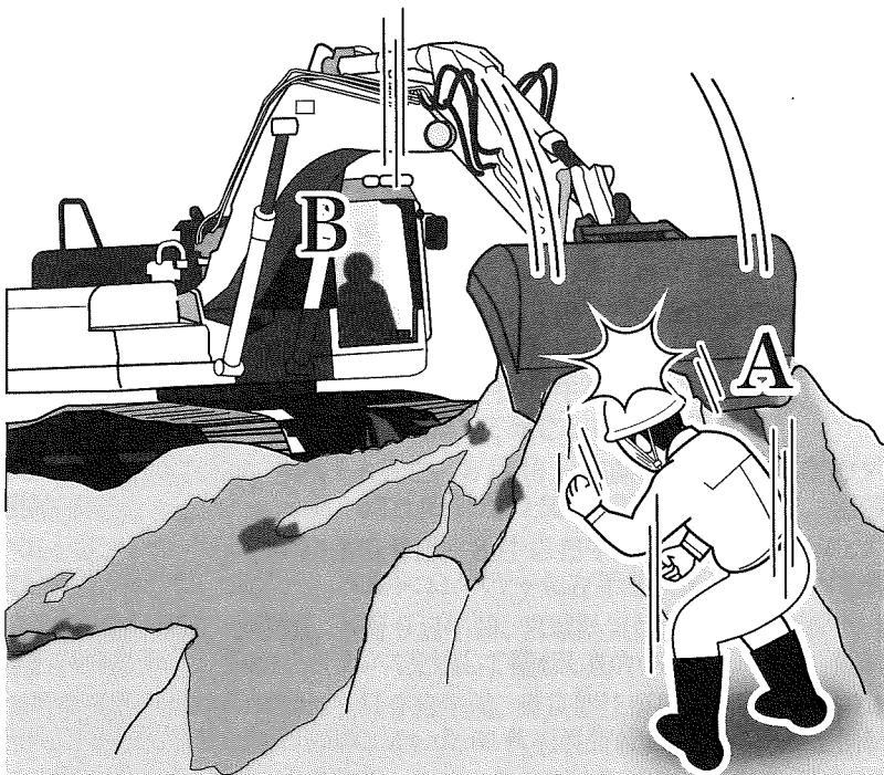
『災害のあらまし』工事現場で、下請け工事業者の作業員（A）が、山積みされた土砂の陰で不要物を取り除いていた際、土砂を移動するため別の下請け業者の作業員（B）が、反対側からドラグ・ショベルで土砂を移動しようとして、土砂の山陰の作業者に気付かず、バケットが被災者の頭部に激突し、死亡したものです。
