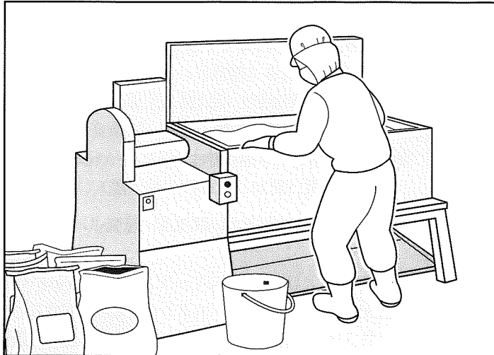
《状況》アームが3秒で1回転する混練器内の食品材料の状態をサンプリングする作業。1日10回程度行う。
