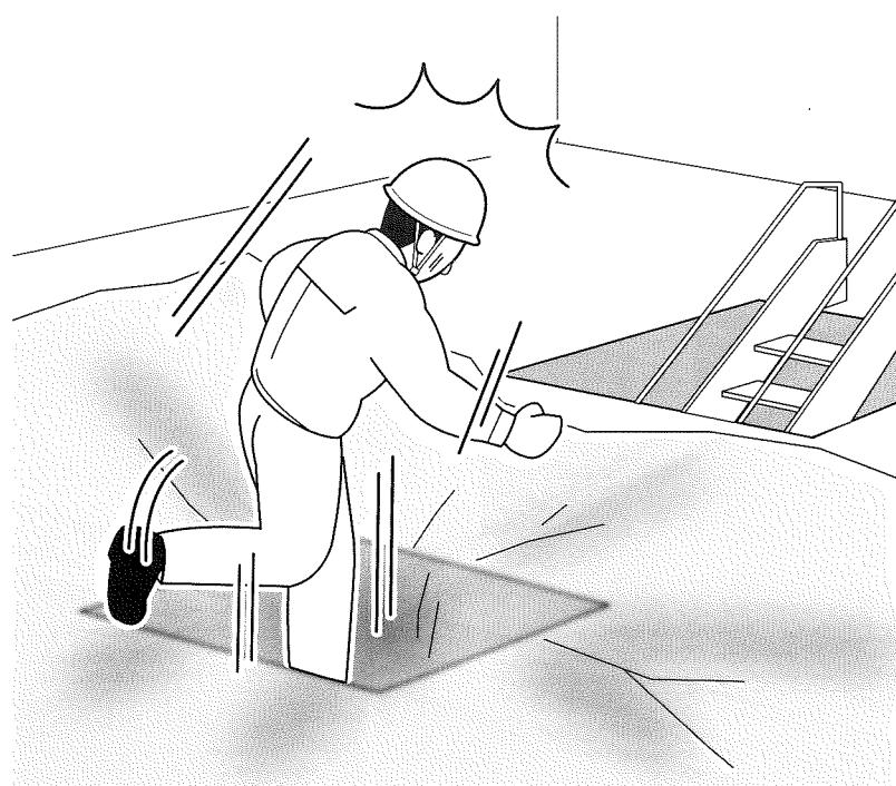
『災害のあらまし』工場の改築工事現場で、塗装会社の作業者（男性、61歳、経験30年）が、天井の吹き付け塗装作業中、階下のコンプレッサーが急に動かなくなつたので、確認のため階段の方向に急いで行く際、床の養生用のブルーシートに覆われていた開口部から4メートル以下の床に墜落して重傷を負いました。
