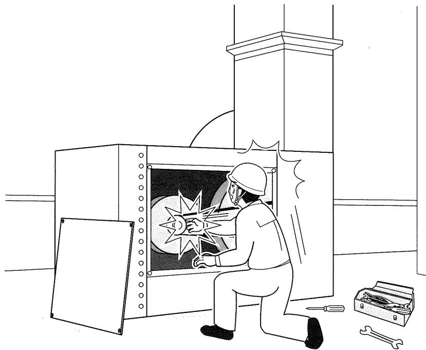
『災害のあらまし』事業所屋上の換気用排風機の点検修理を行っていた作業者（男性・23歳、勤続2年）が、排風機の3本のVベルトを交換する作業を行っていた際、ベルトを排風機のブーリーに馴染ませるためベルトに手をかけて引いたところ、勢い余ってブーリーとベルトに右手第2、
